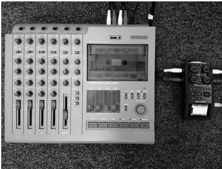
図 18 コンパクトカセットテープの読み取りシステム
